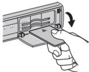
上側のスロットに C-CAS カードを、下側のスロットに B-CAS カードを挿入します。
